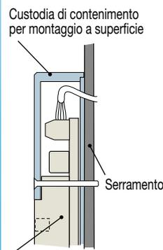
Custodia di contenimento per montaggio a superficie
