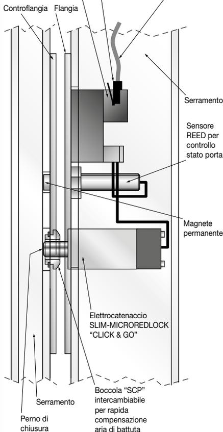
Serie REDLOCK (fail-safe) versione "antipanico" = perno "fuori" quando alimentato, perno "dentro" senza corrente. In caso di incendio, mancando corrente, l'elettrocatenaccio SLIM-MICROREDLOCK si sblocca automaticamente permettendo l'evacuazione senza panico.
