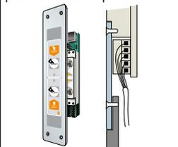
Pulsantiera SLIM-DUALPUSH tipologia 2 a doppio comando individuale. Per incasso complanare "a filo piano" nel ribasso del pannello mediante flangia frontale (per es. da montare su pannello-parete adiacente al serramento sul montante del quale non sono realizzabili scassi).
