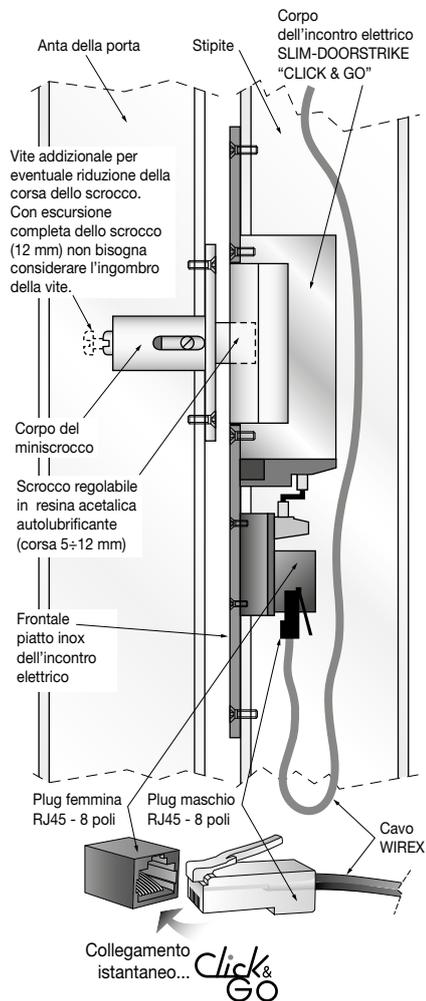
Serie SLIM-DOORSTRIKE (fail-safe) versione "antipanico" = sblocco senza corrente. In caso di incendio, mancando corrente, l'incontro elettrico SLIM-DOORSTRIKE si sblocca automaticamente permettendo l'evacuazione senza panico.
