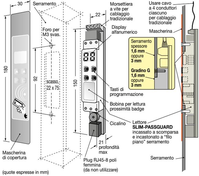
**Tipologia di montaggio 2** complanare nel ribasso
