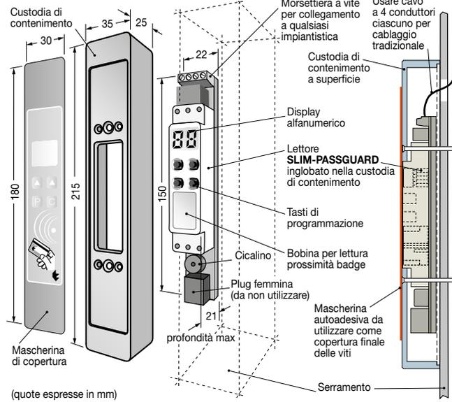
**Tipologia di montaggio 5** incassato a muro
