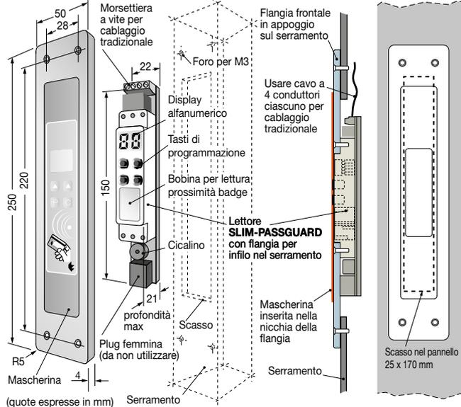
**Tipologia di montaggio 4** in appoggio a superficie
