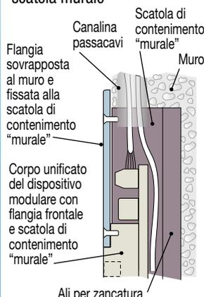
Corpo unificato del dispositivo modulare con flangia frontale e scatola di contenimento "murale"
