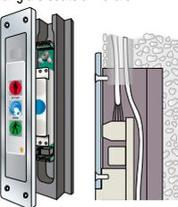
Semaforo SLIM-DUALUX No-touch tipologia 5 per montaggio incassato mediante flangia e scatola murale. Completo di flangia frontale in alluminio anodizzato colore "argento" - 250 x 50 mm, spessore 4 mm, da fissare alla scatola di contenimento in appoggio sul filo muro. Mascherina già inserita e fissata nella nicchia della flangia.
