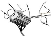
Collegamento multiconfigurabile "FLEXICON" con morsettieria a vite
