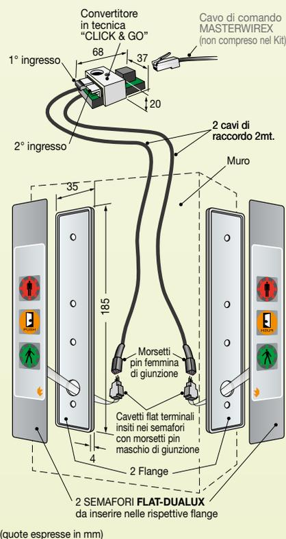
Gruppo semaforico con flangia di supporto ultrasottile per montaggio "a filo piano" su superfici irregolari come intonaco, cartongesso, cemento, travertino o legno, ecc. È una "sottile piastra" elettronica applicabile a parete (su qualsiasi superficie) con 4 piccole viti.
