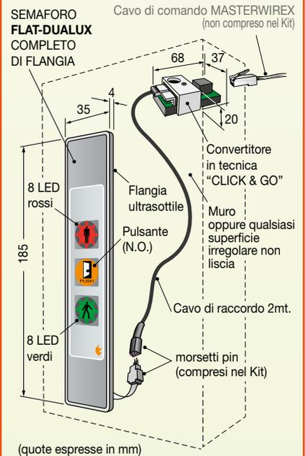
**Esempio di applicazione del semaforo FLAT-DUALUX completo di flangia di supporto anche per superfici irregolari non lisce**
