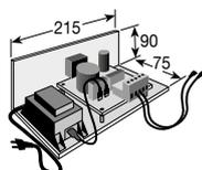
**ESECUZIONE "A GIORNO"** su supporto dissipatore a L con trasformatore (senza custodia, senza gabbia).
