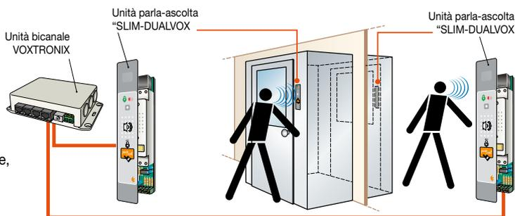
Fig. 1 - Voxtronix in configurazione BASE
